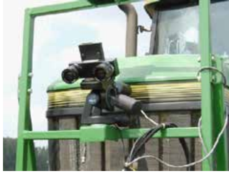
Şekil 19. Traktör Önüne Monte Edilmiş İkili (Stereo) Görüntüleme Sistemi (Kise et al., 2005)
