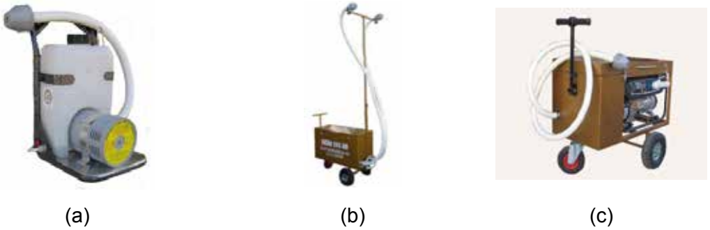
Şekil 25. Sırtta Taşınan (a) ve Elle Çekilen Arabalı Tip (b, c) ULV Makinaları.
