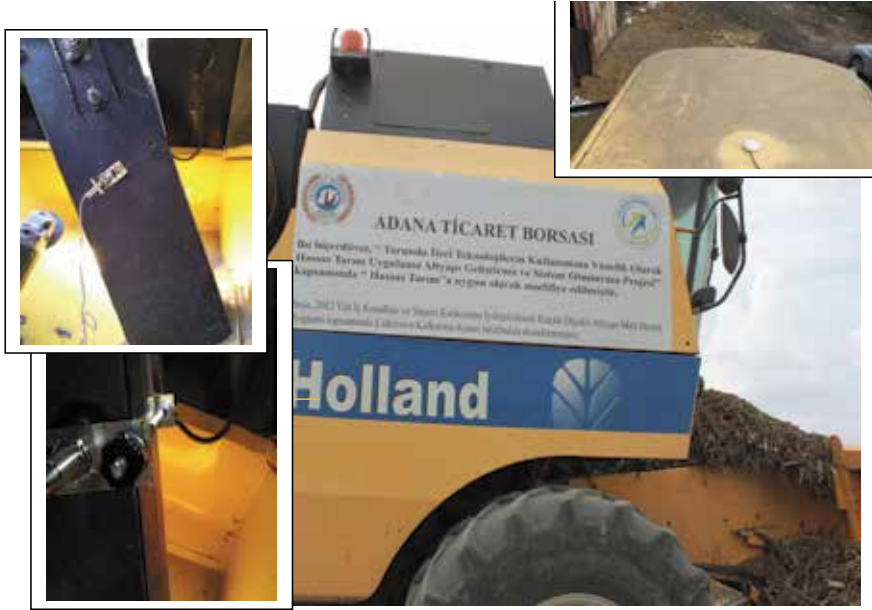
Şekil 3. Adana da verim sensörleri, GPS ve haritalama sistemleri ile donatılan bir biçerdöver (2012)
