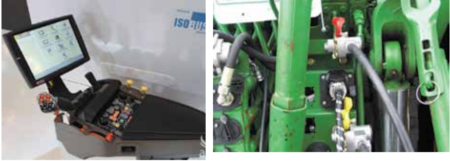
Şekil 15. Traktör Üzerinde Isobus İçin Kullanılan Terminal ve Traktörde Kablo Bağlantı Noktası
