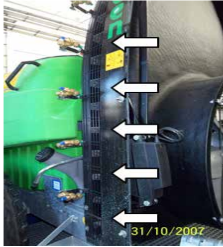
Şekil 9. Hava Akımının Kesilmesini Sağlayan Hidrolik Kontrollü Kapak Sistemi
