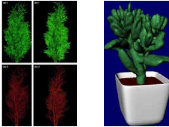
Şekil 16. Yüksek Çözünürlüklü X-Işınlı Bilgisayarlı Tomografi (Dutilleul et al., 2005) ve Nükleer Manyetik Rezonans Görüntüleme (Anonymous, 2014d) Teknikleriyle Bitkilerin 3 boyutlu Görselleştirilmesi
