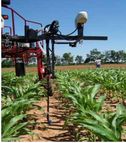
Şekil 11. İlaçlamada Sensör Tabanlı Değişken Oranlı İlaç Uygulama Sistemi
