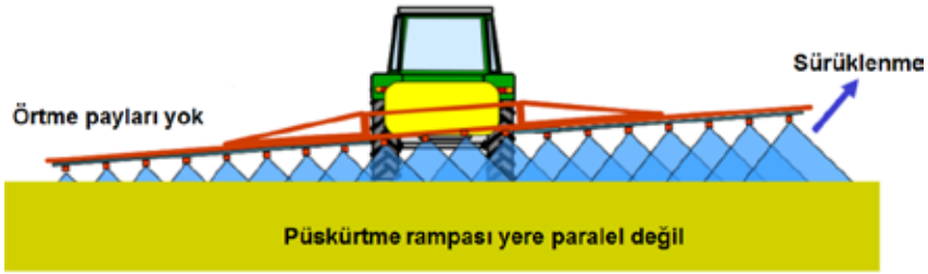
Şekil 22. Yere Paralel Olmayan Püskürtme Sistemi (Roettele et al., 2011).
