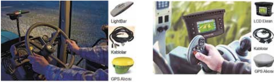
Şekil 6. Manuel (Işıklı Bar Ya Da Lcd Ekranlı) Dümenleme ve Teknolojileri
