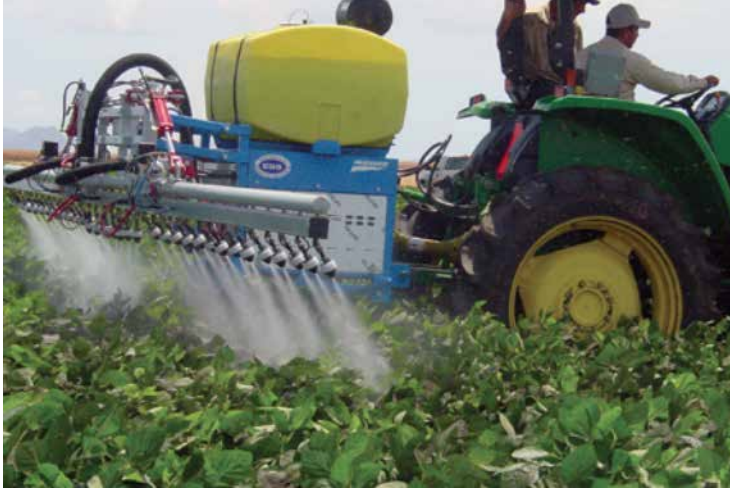
Şekil 10. Elektrostatik Yüklemlü Püskürtme Yapan Bir Tarla Pülverizatörü (Anonymous 2013h).
