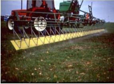
Şekil 11. Püskürtme Sistemi Kuruyucu Örtüsüne Sahip Tarla Pülverizatörleri (Resimler, OSU web sayfası)
