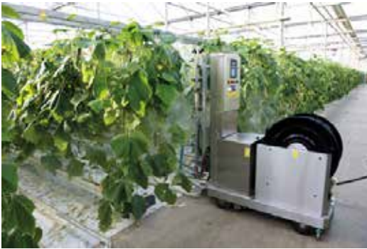
Şekil 27. Seralarda Kullanılan Kendi Yürür Otomatik İlaçlama Makinaları
