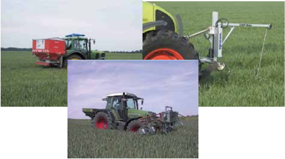
Şekil 8. Sensör Tabanlı Farklı Ürün Algılama ve Değişken Oranlı Gübre Uygulama Teknolojileri
