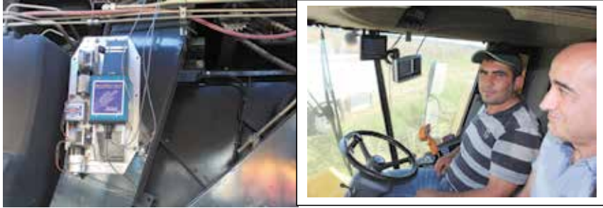
Şekil 4. Ülkemizde bir biçerdövere takılan protein sensörü ve monitörü (Adana, 2013)
