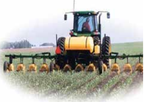
Şekil 11. Püskürtme Sistemi Kuruyucu Örtüsüne Sahip Tarla Pülverizatörleri (Resimler, OSU web sayfası)
