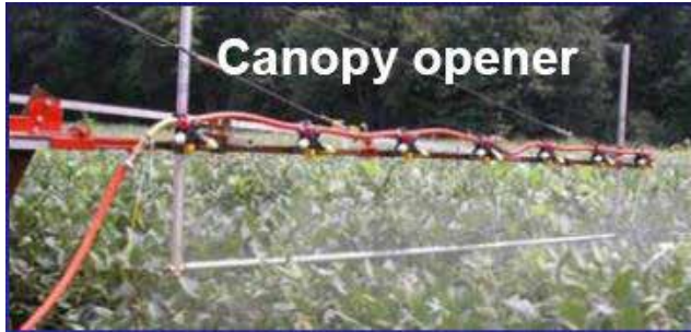
Şekil 12. Mekanik Ürün Açıcı (Zhu et al., 2006)
