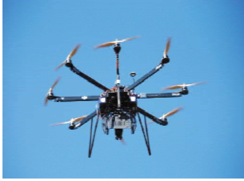
Şekil 9. Tarımsal amaçlı kullanılan bir UAV (GPS ve kamera sistemi ile birlikte)
