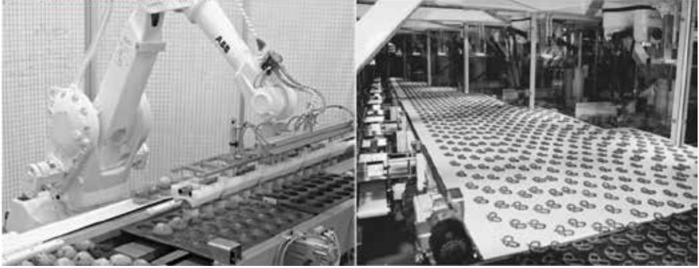
Şekil 2. Bir fırın montaj hattında kullanılan a) Endüstriyel robot b) Delta robot (Gray ve Davis 2013)
