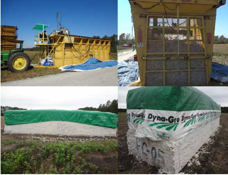
Şekil 5. Pamuk presleme modülü ile pamuk modülünün sıkıştırılması
