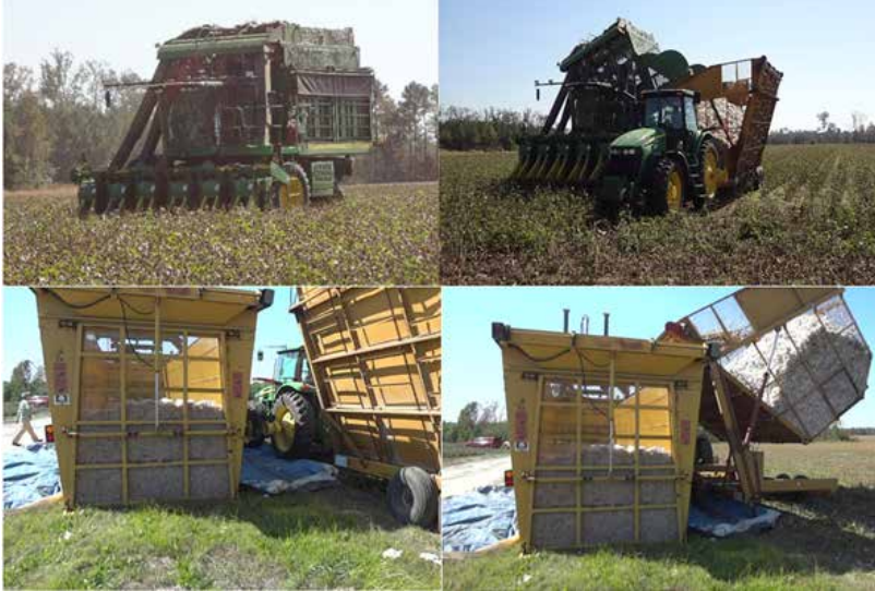
Şekil 4. Pamuk hasat makinesinden alınan pamuğun tarım arabası ile pamuk presleme modülüne taşınması
