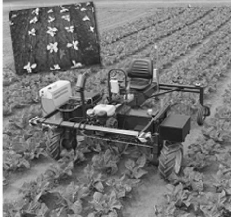
Şekil 16. Hareketli Platformun Önüne Yerleştirilen Multispectral Kamera ile Çekilen Görüntülerle Kontrol Edilen Selonoid Valfli Bir İlaçlama Makinası Görülmektedir
