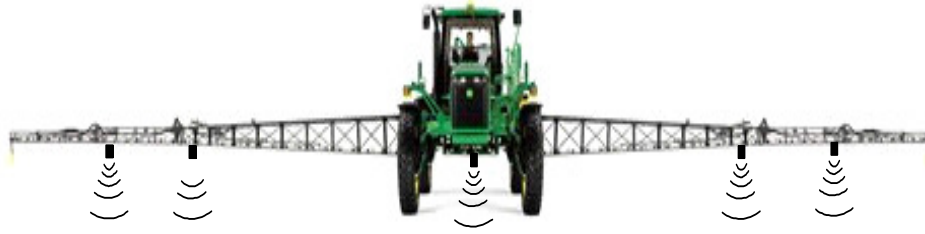
Şekil 12. Ultrasonik Sensörlü Otomatik Yükseklik Kontrolü (Wolf, R.E., 2009)
