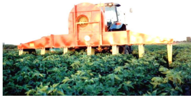
Şekil 8. "Drop Tube" Adı Verilen Hava Akımlı Düşey Rampa Uygulaması
