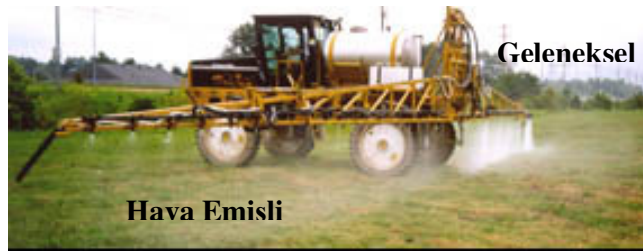
Şekil 18. Hava Emişli ve Geleneksel Yelpaze Hüzmeli Memelerin Karşılaştırılması
