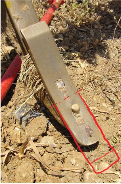
Şekil 3. Pulluk ve çizel uç demirlerinde aşınarak kaybolan malzeme büyüklüğü ve uç demiri geometrisindeki değişim (orijinal)
