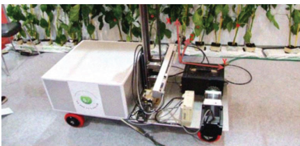
Şekil 4. Sera içerisinde görüntü işleme teknolojisi ile bitkilerde haşere kontrolü ve ilaçla çalışması.
