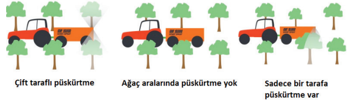
Şekil 3. Ağaç ilaçlamasında püskürtme sisteminin çalışma şekli (Anonim, 2017c)
