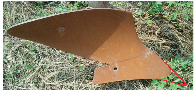
Şekil 3. Kazayağı tipi uç demirinde aşınmanın sonuçları ve aşınma direncinin iyileştirilmesi için yapılan kaynaklama
