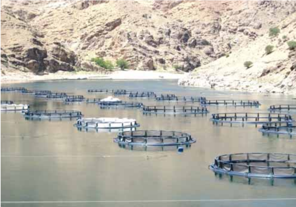
Şekil 6. Yüzdürücü Çerçevesi Bulunan Yüksek Yoğunluktaki Polietilen (HDPE) Kafesler
