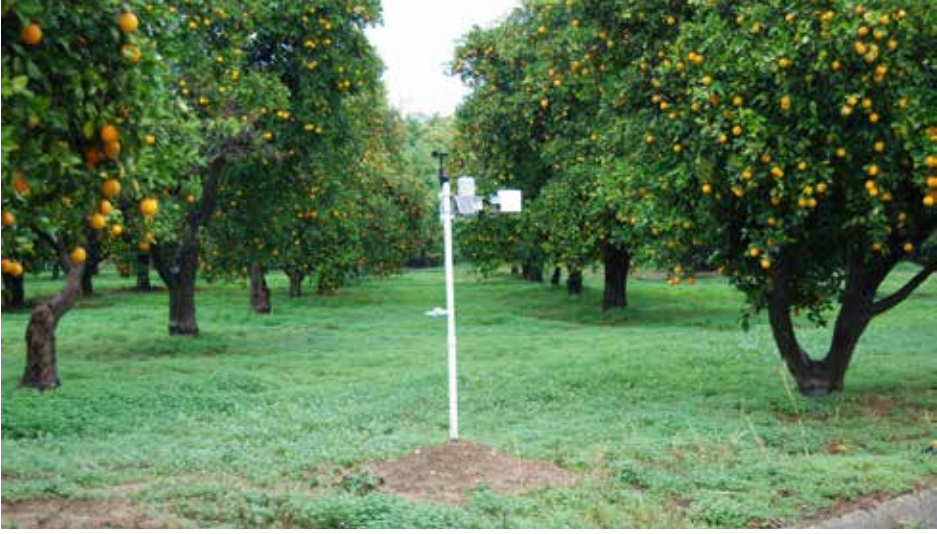
Şekil 2. Aynı anda farklı verileri alabilen tahmin-uyarı sistemi (sıcaklık, nem, yağış, toprak nemi, rüzgar hızı ve yönü, toprak su potansiyeli, güneşlenme süresi, ışıklandırma, don alarmı,vs.).
