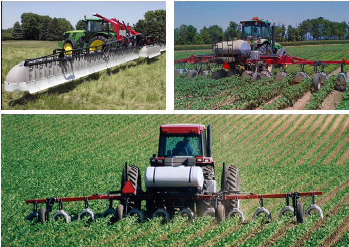
Şekil 8. Koruyucu örtülü püskürtme sistemine sahip tarla pülverizatörleri (Anonymous 2024g)
