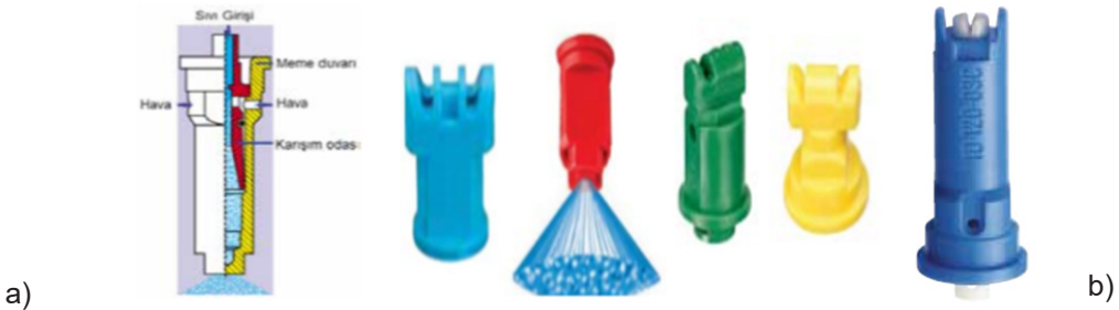
Şekil 1. a) Hava emişli memenin çalışma prensibi b) Piyasaya sürülen bazı hava emişli meme tipleri (Güler vd. 2010, Dursun vd. 2015)
