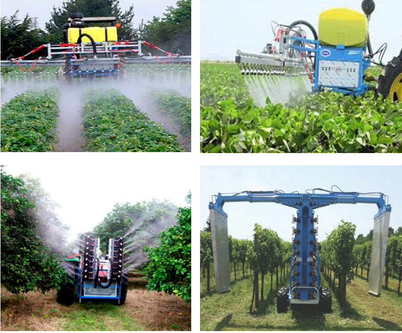
Şekil 7. Elektrostatik yüklemeli tarla ve bağ-bahçe pülverizatörleri (Anonymous 2024d, e, f)
