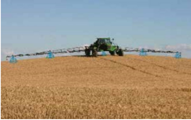
Şekil 5. Aktif dengeleme sistemli kendi yürür tarla pülverizatörü (Anonymous 2024c)
