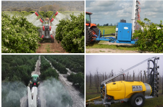
Şekil 10. Kule tip pülverizatörler (Anonymous 2024i, j, k, l)
