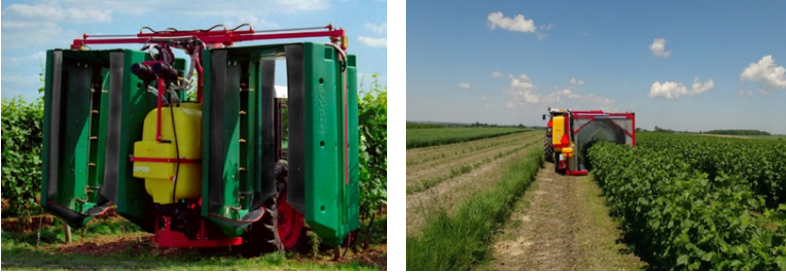
Şekil 9. Tünel pülverizatörler (Anonymous 2024h, i)
