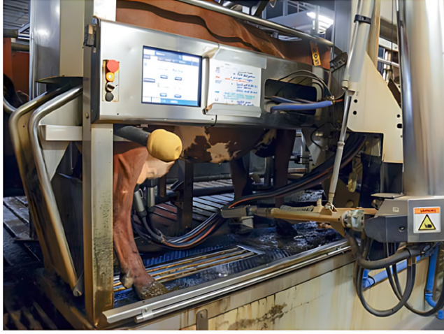
Şekil 2. Sağım Robotlarında Yer Alan Robotik Kol Ünitesi (Bosona ve Gebresenbet, 2021)
