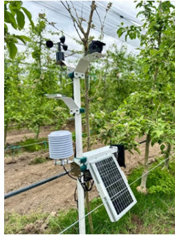
Şekil 5. Erken uyarı ve tahmin sistemi (hava ve toprak sıcaklık ve nem, yağış, yaprak ıslaklığı, toprak nemi, rüzgar hızı ve yönü, toprak su potansiyeli, güneşlenme süresi, ışıklandırma vb. ölçen bir cihaz.) ( https://www.gorsentam.com )
