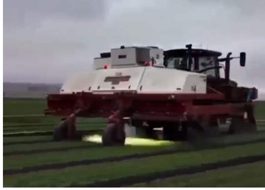
Şekil 10. Otomatik yabancıot saptayabilen lazerli tarım robotu
